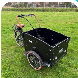
Triporteur à assistance électrique, adapté au transport de 4 enfants en bas âge (bâche de pluie disponible).
