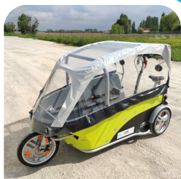
Vélo-bus à assistance électrique, 8 places pour le transport groupé de public en bas âge.
